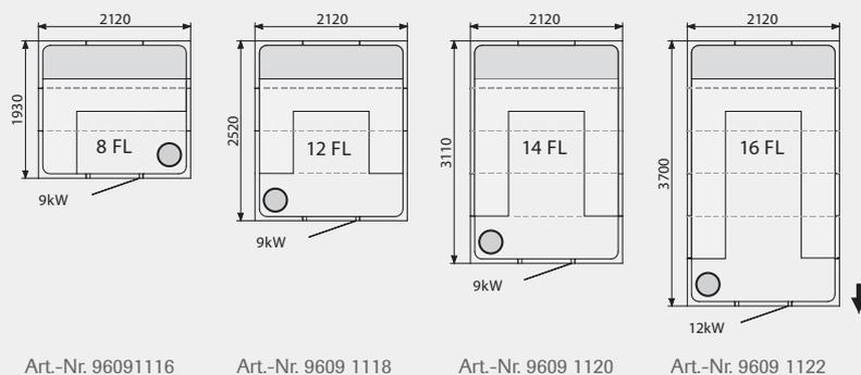
Die gestrichelten Linien zeigen die Deckenausdehnung. Die Kabine lässt sich in Pfeilrichtung erweitern. Für andere Abmessungen und Ausführungen unterbreiten wir Ihnen gern ein Angebot. Die verglasten Wandbereiche und Servicewände sind in den Breiten 398, 588 und 778 mm lieferbar. Sie können ohne Zusatzkosten den entsprechenden Bereich der Excellent-Kabine ersetzen.
