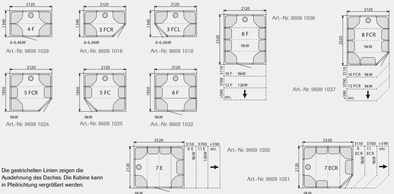
Die gestrichelten Linien zeigen die Ausdehnung des Daches. Die Kabine kann in Pfeilrichtung vergrößert werden.
