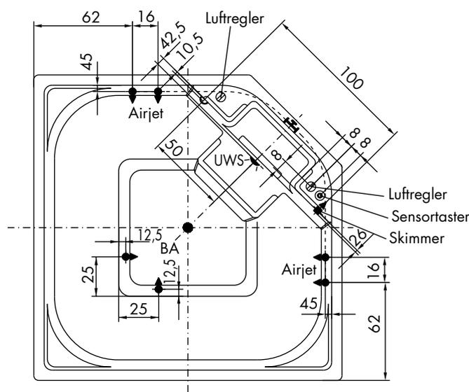
Standard-Positionen für Einbauteile
