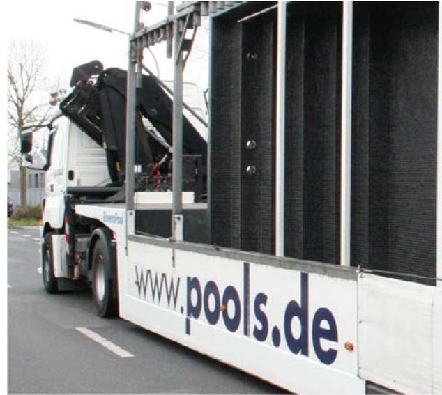
*Die Konstruktion wird im Werk und nicht auf der Baustelle gefertigt. Unser Spezialtransporter bringt Ihren Pool hochkant oder quer gefahren an die Baustelle.*
